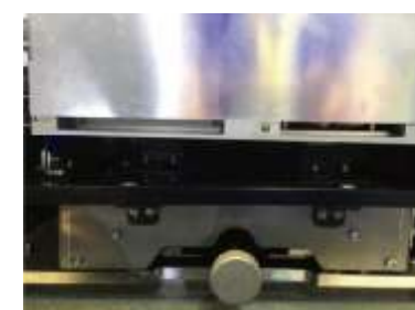
Carrello dotato di sistema anti collisione per la protezione delle testine di stampa
