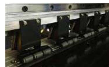
Binario di guida silenzioso e ad alta precisione
